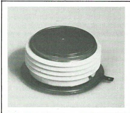
Les semi-conducteurs de grande puissance destinés à la traction ferroviaire sont présentés en boîtier « Press Pack ». (Cliché Thomson CSF.)
