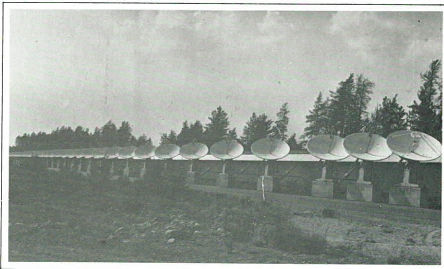
Fig. 19. - L'interféromètre à 32 réflecteurs paraboliques du Parc Algonquin (Canada). Ces antennes permettent entre autres de capturer quotidiennement à midi les micro-ondes émises par le soleil et qui atteignent la terre (doc. CNRC).
