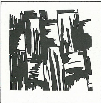
Fig. 6. - Style 7637; 408 brins dans la chaîne, 816 brins dans la trame.
