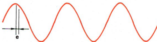
Fig. 2. — Pour asservir un oscillateur de 27 MHz sur une référence de 1 MHz, on procède non pas par division programmable, mais par un échantillonnage qu'on repère toutes les 27 périodes.
