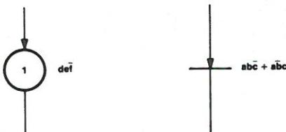
Fig. 6a (à gauche). — Symbole de l'étape 1 associée à la configuration des sorties d=1, e=1, f=0.
