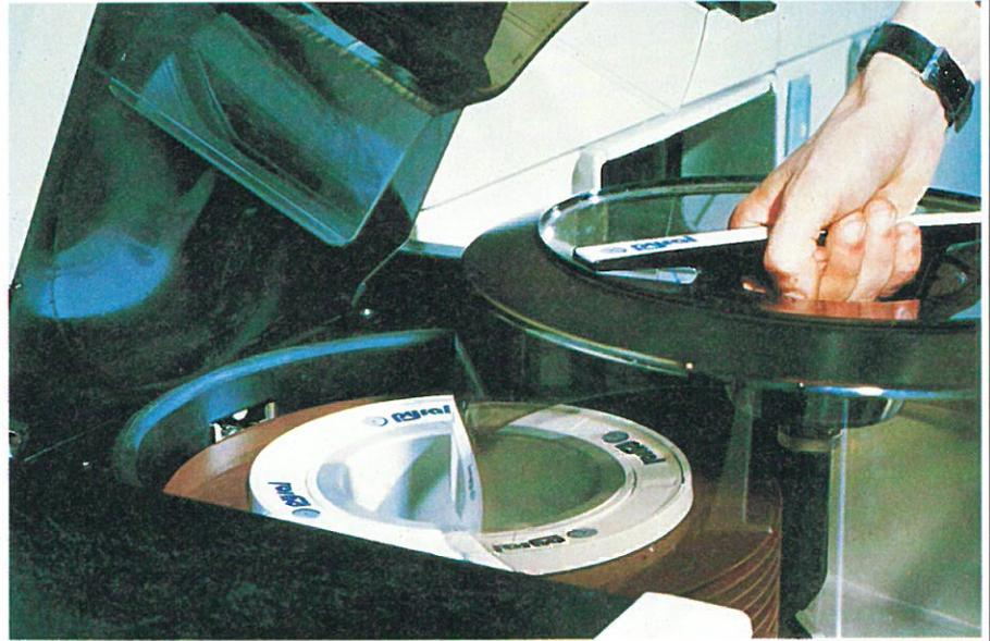
Fig. 2. — Cartouche disc-pack haute densité (photo Courtin-Rhône-Poulenc).
