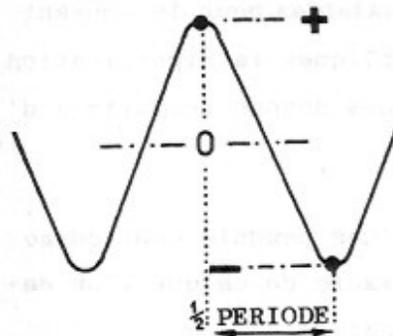
L'énergie que possède le balancier passe d'un maximum positif à un maximum négatif.
