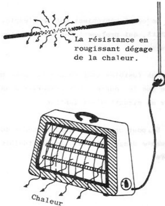
Si cette capacité est inférieure au courant qui passe réellement, les charges électriques, ne trouvant pas une section suffisante pour s'écouler, produisent de la chaleur.
