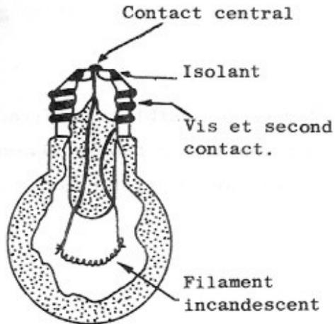
Les lampes électriques ont un filament qui, parcouru par le courant, devient incandescent jusqu'à émettre de la lumière.
