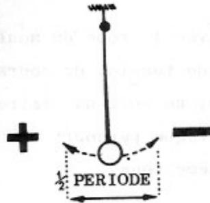
L'énergie du balancier ne se déplace plus de haut en bas, mais de gauche à droite et vice versa d'un point maximum à un point minimum puis à un point maximum, etc...
