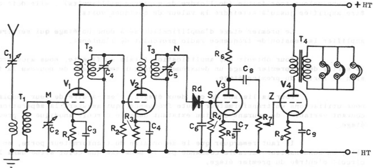
Schéma didactique d'un récepteur à amplification directe.
