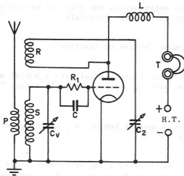
La tension "H.F." que l'on a sur la plaque de la triode est obligée de passer à travers le circuit formé par la bobine "R" et le condensateur "C<sub>2</sub>" parce qu'il existe l'impédance "L" en série dans l'autre branche du circuit.
