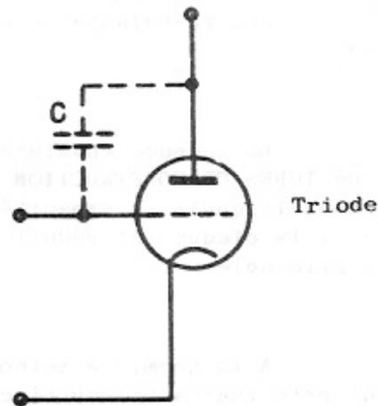
La présence de cette capacité dans le tube est l'un des principaux motifs de limitation dans l'utilisation du tube.
