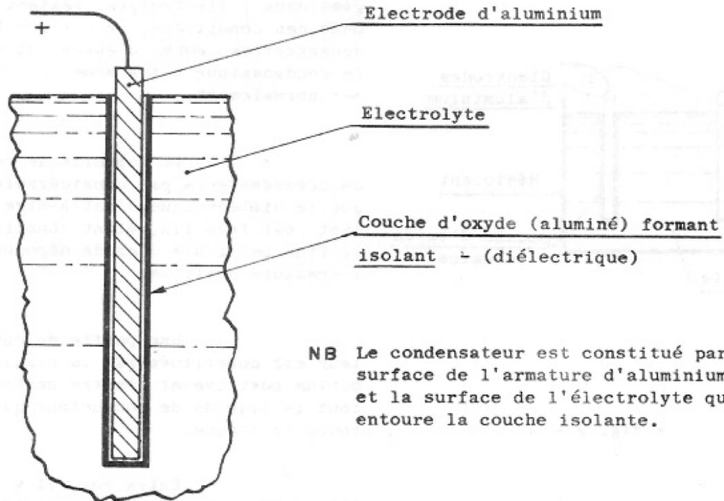
**NB** Le condensateur est constitué par la surface de l'armature d'aluminium et la surface de l'électrolyte qui entoure la couche isolante.
