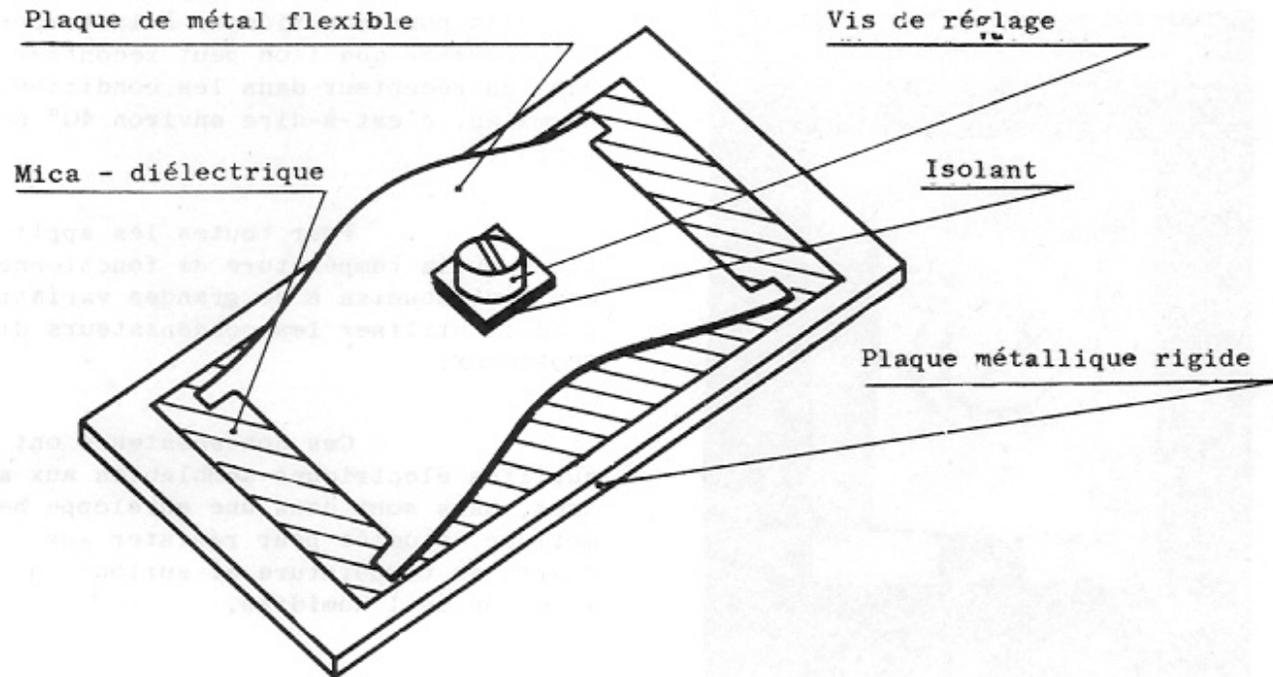
N.B.- En tournant la vis de réglage, la plaque flexible se rapproche ou s'écarte de l'autre et la capacité varie.
