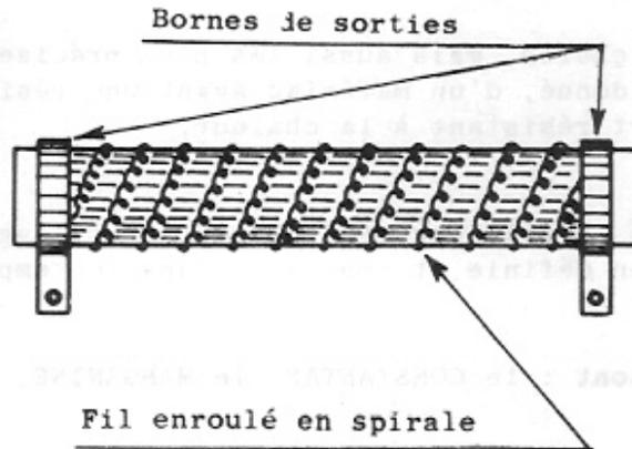
La Fig. 2- représente une résistance où le support présente une cannelure à vis sans fin sur laquelle est tendu le fil résistif, enroulé sur lui-même de façon à former une spirale.
