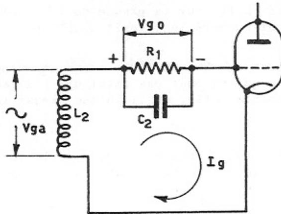
$V_{ga}$  = Tension alternative appliquée sur la grille par l'effet de réaction.
