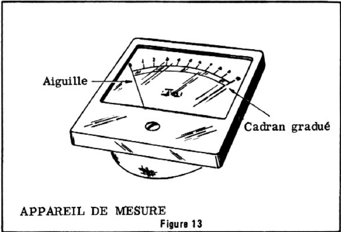
Tous les appareils de mesure sont utilisés dans un secteur d'application déterminé, par exemple le compteur de vitesse des automobiles se déplace autour d'un cadran de 0 à 150 et même 200 km/h ; et les balances des boulangers indiquent les poids jusqu'à 1 kg ; la valeur maximale que ces appareils de mesure peuvent indiquer est la **FIN DE L'ECHELLE GRADUEE**.
