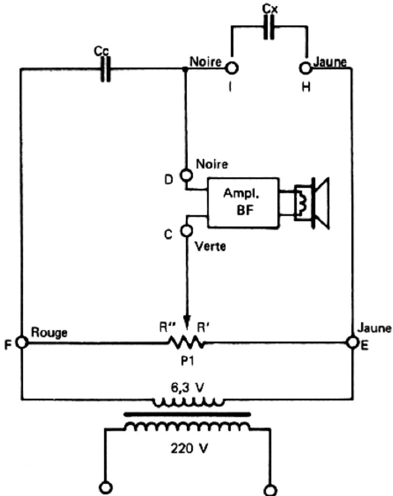
PONT POUR LA MESURE DES CAPACITES
