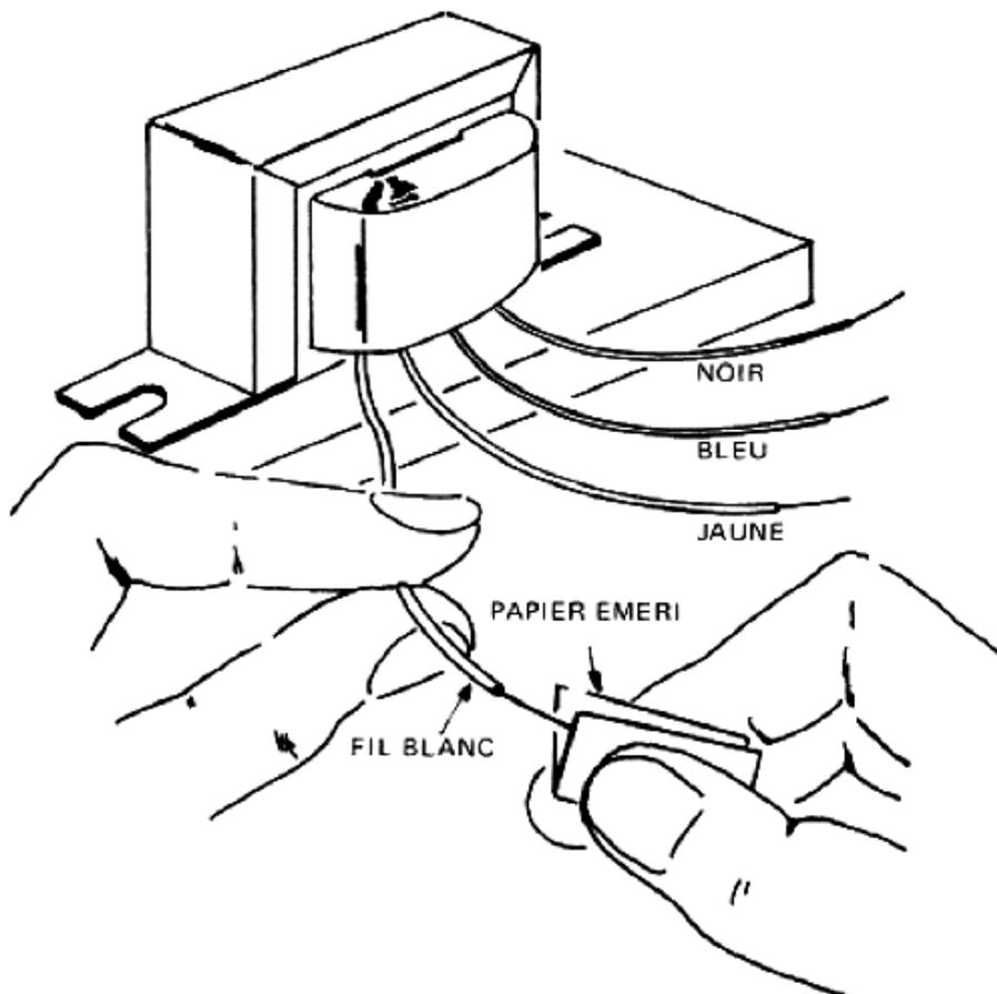
**NETTOYAGE DU VERNIS ISOLANT SUR LES SORTIES
