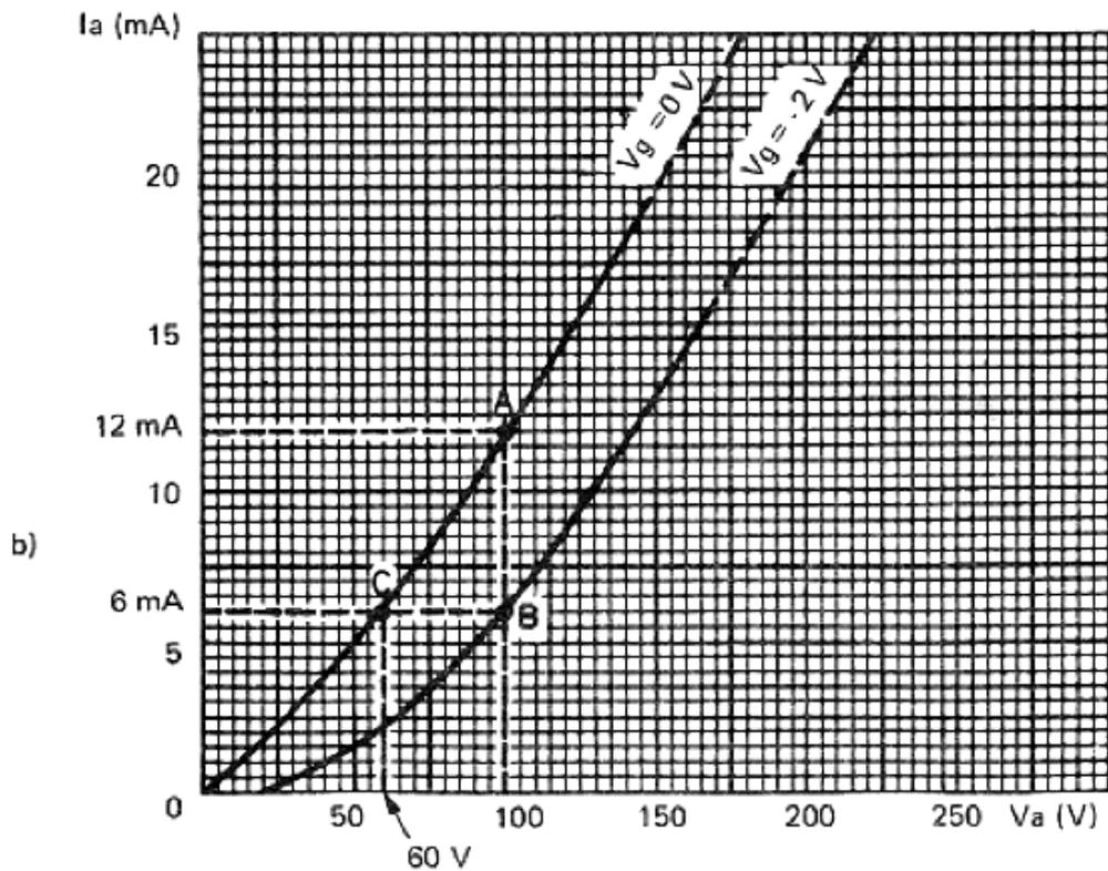
COURBES CARACTERISTIQUES D'UNE TRIODE AVEC DES TENSIONS DE GRILLE DE 0V ET DE 2V
