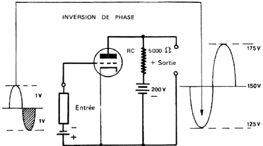
Inversement, lorsque L'ALTERNANCE NEGATIVE du signal d'entrée rend LA GRILLE PLUS NEGATIVE, LE COURANT DANS LE TUBE DIMINUE. La chute de tension dans Rc diminue et LA TENSION DE SORTIE AUGMENTE.
