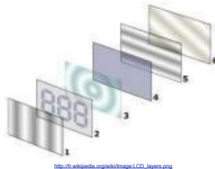
Fig. 29. Affichage LCD simple par segments et par pixels
