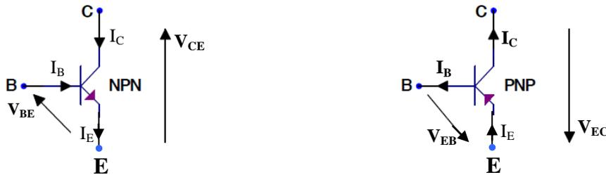
Les trois électrodes d'un transistor bipolaire se nomment : émetteur (E), base (B) et collecteur (C).
