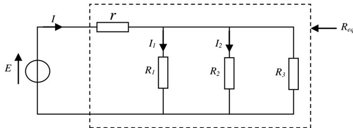
Fig.I.5. Exemple d'application du pont diviseur de courant sur des résistances en parallèle.
