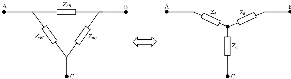
Fig.1.10. A gauche: montage triangle. A droite: montage étoile.
