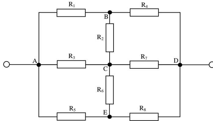
Fig.1.11. Exemple de calcul de la résistance d'un dipôle en utilisant le théorème de Kennelly.
