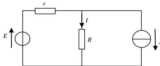
Fig.I.6. Exemple d'application de théorème de superposition.
