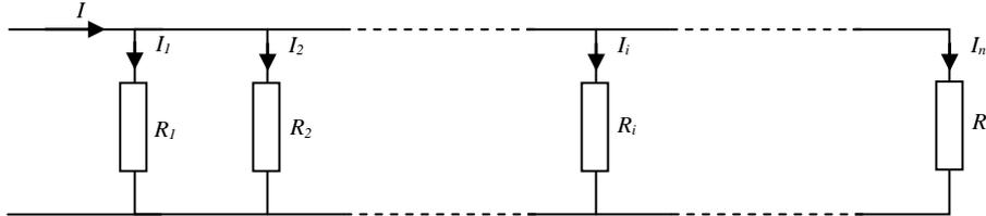
Fig.I.4. Application du pont diviseur de courant sur des résistances ou des impédances en parallèle.
