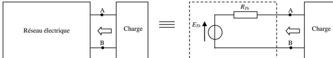
Fig.1.7. Circuit de Thévenin équivalent à un circuit électrique.
