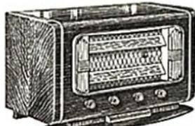
Batterie secteur « type Caravane » - 6 volts - Vibreurs 4 broches - Secteur alternatif 110, 115, 145, 220, 245 volts - 5 lampes : ECH42 - EAF42 - EF41 - EL41 - EM34 - Redresseur Sélénium - H.-P. 21 cm Audax - AT, PU - H.-P. supplémentaire - OC - PO - CO - BE - PU - Dimensions : long. 560, haut. 350, larg. 260. Poids : 10 kg 500. Prix .... **170.00**
