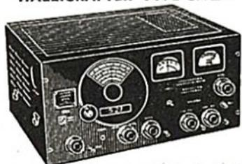
15 tubes, 6 gammes de 550 kc à 42 Mc. 2 cadrans démultiplificateurs gyroscopiques. CV d'accord et CV de band-spread, filtre cristal BFO à note variable. S-mètre, sélectivité variable par commutateur à 6 positions. Ajustement de l'accord antenne par CV. Push-pull final par 2x6V6. Alimentation secteur in-corporée ..... **1.250,00**
