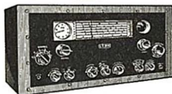
13 tubes série octale dont 2 étages HF et 3 étages MF. Gamme couverte de 550 kc à 35 Mc en 5 gammes. Filtre à quartz, sélectivité variable VCA progressif par commutateur 6 positions. Potentiomètre de gain HF, MF et BF. S-mètre BFO, cadran démulti de grandes dimensions avec trotteuse 2 vitesses. Alimentation secteur alternatif incorporée **650,00**
