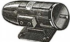
Type 3108. Entrée 24 volts continu 5,5 A. Sortie 3 x 115 volts 0,4 A - Alternatif - Service continu à 6180 t/m - Puissance 70 - Compound - Axe de sortie - long. 20 mm - diam. 8 mm - Encombrement : 270 x 105 mm - Poids : 6 kg 400. Prix ..... **65.00**
