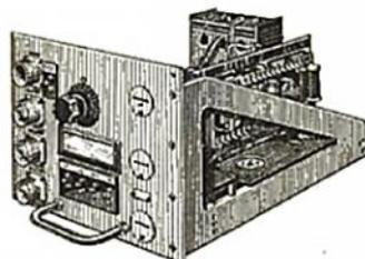
pouvant servir pour un ensemble de montage comportant : alimentation stabilisée HF - Alimentation BT redressée - Selfs - Condensateurs tropicalisés - Résistances, atténuateurs et diverses autres pièces de qualité (voir sur place) - Dimensions : face avant 240 x 190 x 355 mm.
