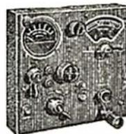
Comprend : 1 magnifique démultiplicateur rapport 1/60, 1 contacteur de gammes 3 positions, 1 potentiomètre bobiné 10 Ω 20 W - de 300+500 Ω graphite - 1 jack pour PL55 - 1 inverseur unipolaire, de nombreuses résistances et un appareil de mesure de 0 à 5 MA pouvant servir de 5 Mètre.
