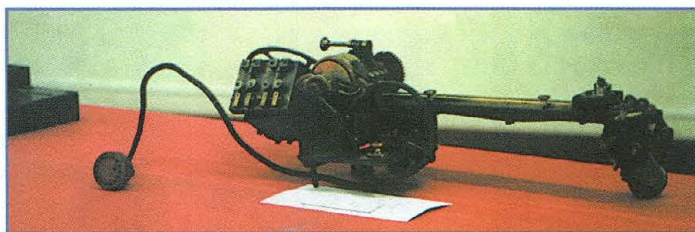
Fig.3 Récepteur système "Rowland".
