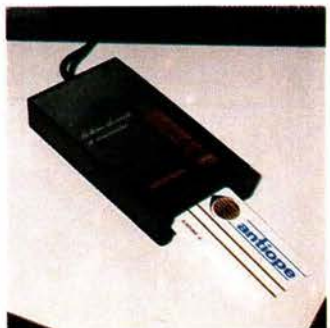
Boîtier Grundig d'accès conditionnel à certains services ANTIOPE.
