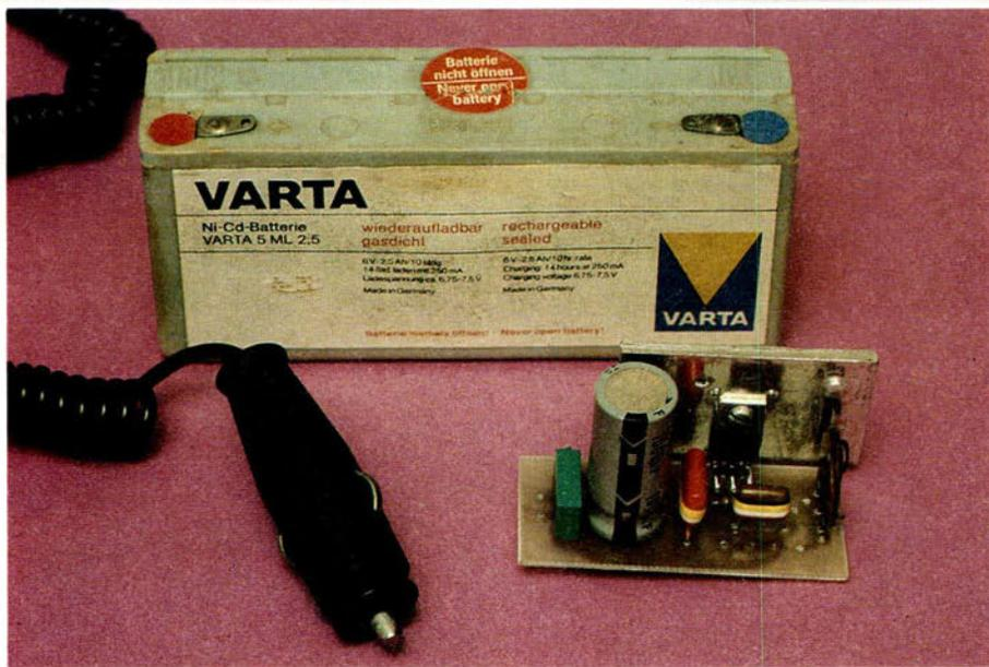
Pratiquement tous les « adaptateurs » vendus à moins de 50 F se composent d'un transfo médiocre (un bon transformateur coûte plus cher que ce genre de bloc secteur !), d'un pont redresseur et d'un condensateur de quelques centaines de microfarads, le tout complété par une résistance en série pour les modèles à tension réglable.
