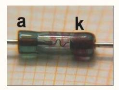
Elle est assez difficile à dénicher dans le matos de récupération; je l'ai remplacée par une diode au germanium d'un magnétoscope (AA119).
