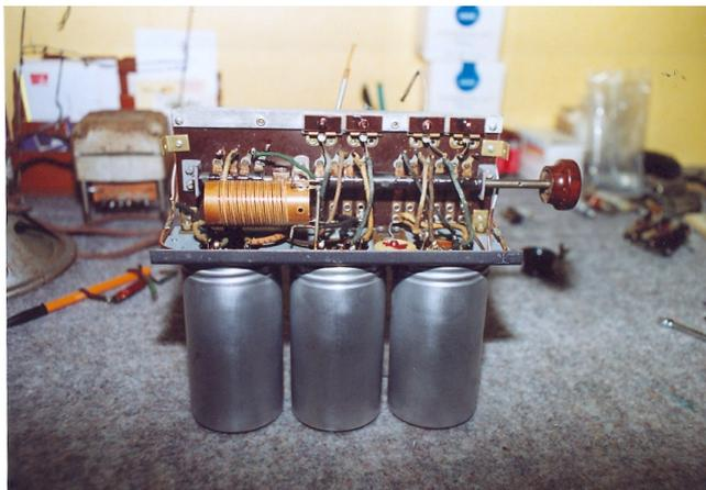
Il faudra par la suite que je refasse aussi tout le câblage du bloc car les fils sont cuits. Puis câblage des lignes de masse, avec encore des cosses à ne pas oublier au niveau des blindages des FI.
