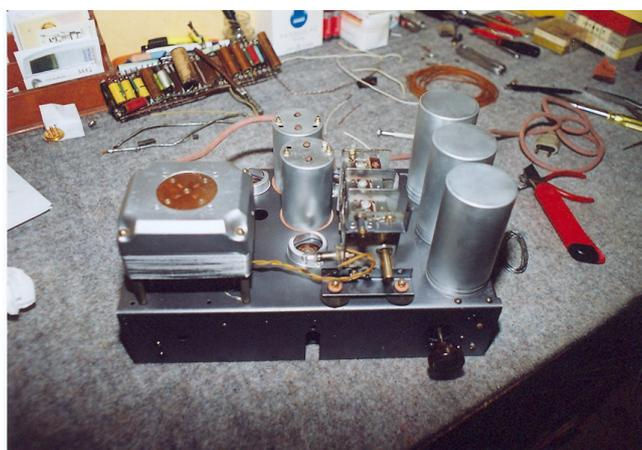
Le transfo reposé sur le châssis.
