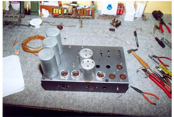
Les fils d'alim (+HT et polar) qui rentrent dans les bobines ont été changés aussi. Le bloc comporte aussi deux bobines à air que j'ai du remonter après remise en place du bloc sur le châssis.
