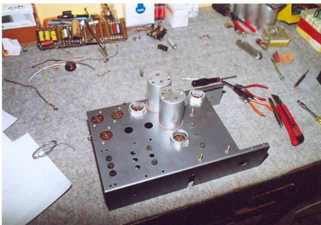
Le plus ch...t là dedans c'est d'arriver à remettre les contre-écrous à la bonne longueur pour que le boîtier plaque bien sur le châssis du poste, car entre le boîtier et le châssis il y a une rondelle de carton, le tout sans casser la bakélite du haut de la FI.
