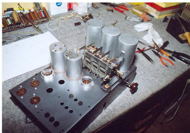
Photo ci-dessus, c'est le CV remonté sur le châssis. J'en ai profité pour changer les fils blindés qui partent du CV aux grilles des tubes. Sous le CV il y avait des cales de caoutchouc que j'ai du refaire en prenant de la sangle de réservoir de camion (oui, oui).
