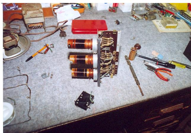
Sur la photo ci-dessus, on peut voir les lames de contacts (qu'il a fallu dessouder). Posée sur la table, à droite du bloc, la grande tige qui comporte les cames de commutation.
