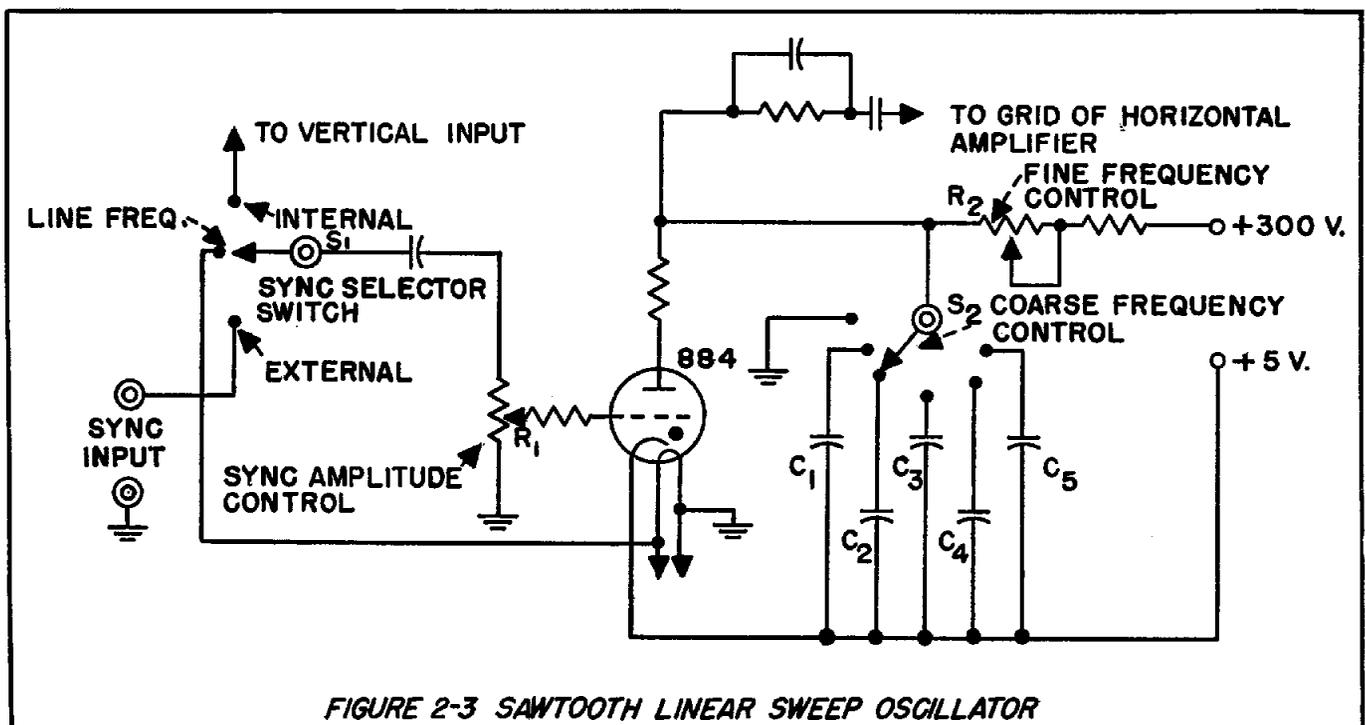
FIGURE 2-3 SAWTOOTH LINEAR SWEEP OSCILLATOR
