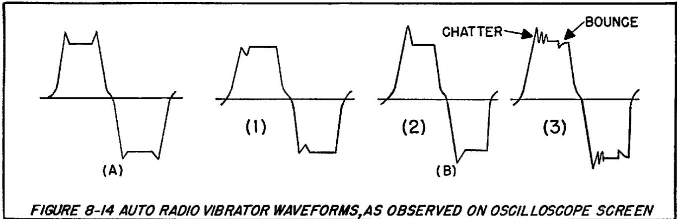
FIGURE 8-14 AUTO RADIO VIBRATOR WAVEFORMS, AS OBSERVED ON OSCILLOSCOPE SCREEN
