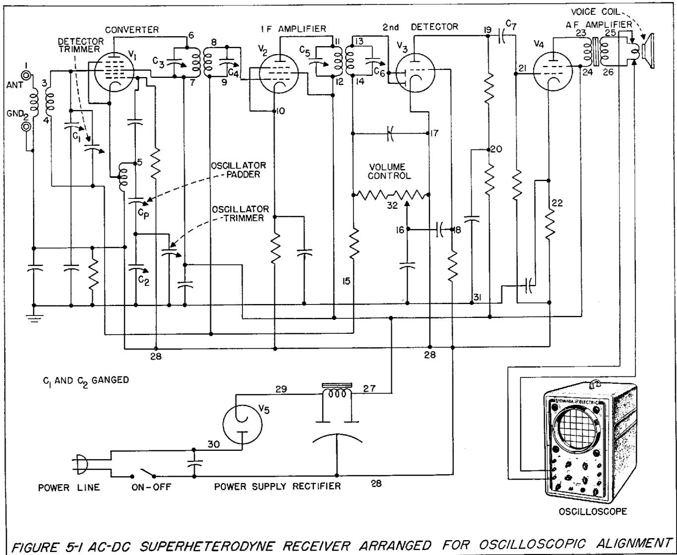
FIGURE 5-1 AC-DC SUPERHETERODYNE RECEIVER ARRANGED FOR OSCILLOSCOPIC ALIGNMENT
