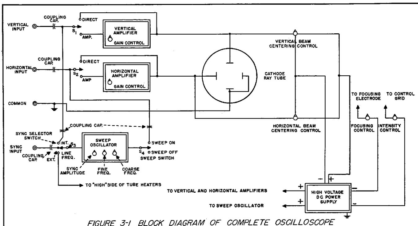
FIGURE 3-1 BLOCK DIAGRAM OF COMPLETE OSCILLOSCOPE
