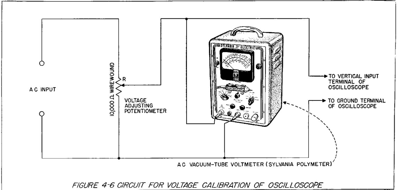
FIGURE 4-6 CIRCUIT FOR VOLTAGE CALIBRATION OF OSCILLOSCOPE
