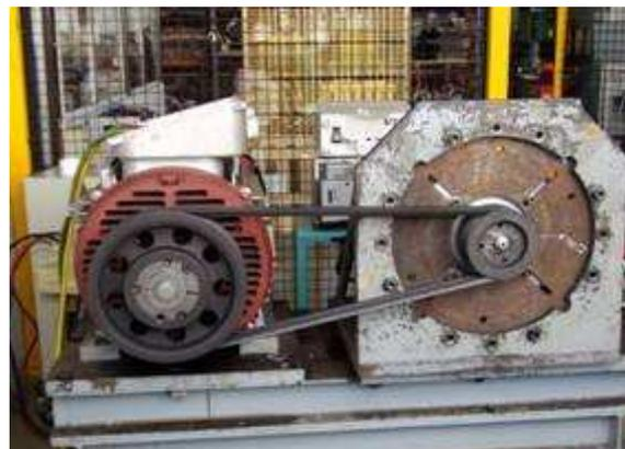
Figure 5.9: Banc pour les essais en génératrice
