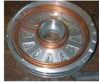
Figure 5.7: Circuit de refroidissement
