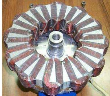
Fig. 1.8 : Bobinage concentré pour machine à flux axial [MAR 06]
