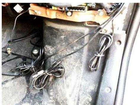
Explication : Comme les antennes sont livrées avec un câble monté usine de 4 ou 5m avec connecteur, les monteurs enroulent le surplus. Résultat : **passable en VHF, mauvais en UHF !**
