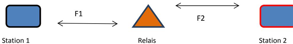
Ce que le relais reçoit sur la fréquence F1 est retransmis instantanément sur la fréquence F2 et inversement. Il est constitué de deux postes émetteurs-récepteurs associés via une connexion spécifique pour remplir cette fonction de relais automatique. Chaque poste ayant son antenne.
