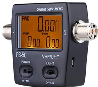
**Wattmètre-tosmètre digital à lecture directe.** Ici un RS-50, 1 calibre 120W, BP de 125 à 525Mhz. La puissance incidente, la puissance réfléchi et le ROS (SWR) sont indiqués directement.
