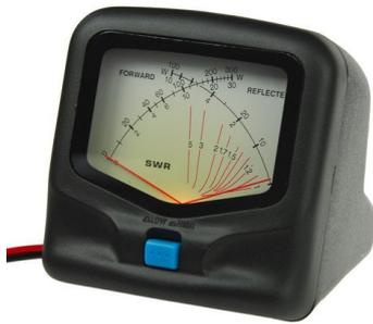
**wattmètre-tosmètre à aiguilles croisées.** Ici un RX-20, 2 calibres 30W et 300W, BP 1,8 à 200Mhz (VHF), fonctionne sans pile. Il existe le RX-40 qui couvre aussi l'UHF basse, 2 calibres de 15W et 150W.
