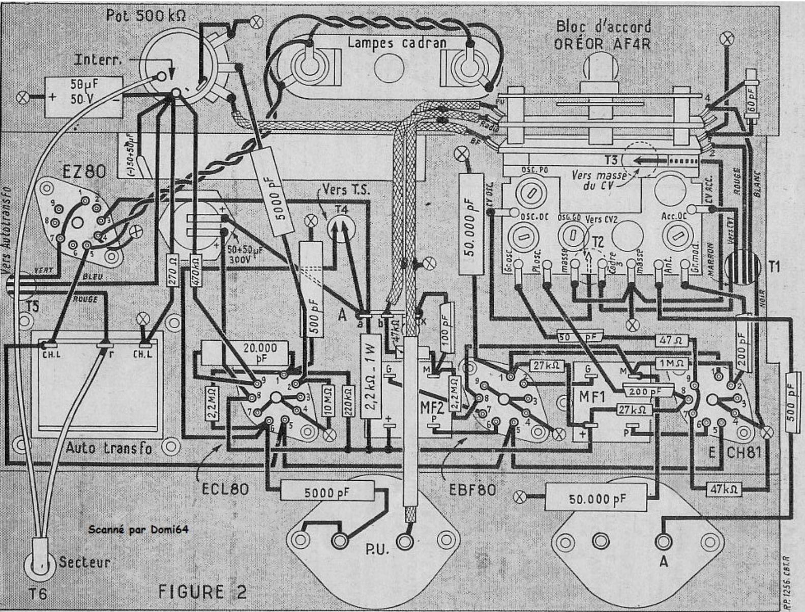
locale appliquée à la troisième. Il en résulte dans le circuit plaque un courant de fréquence intermédiaire qui est sélectionné par le transformateur MF1. Ce transformateur l'applique à la grille de commande de la lampe moyenne fréquence dont le rôle est de l'amplifier. Cette lampe moyenne fréquence est la section pentode d'une EBF80.
