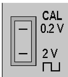
Ces deux sorties **CAL** délivrent des signaux carrés d'amplitude 0,2 V et 2 V à 50 Hz, respectivement. Ces signaux sont utilisés pour vérifier que le scope est correctement calibré.
