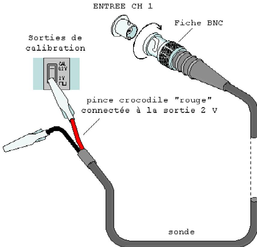
Nous allons à présent vérifier le calibrage du scope, en utilisant la source interne CAL prévue à cet effet (elle se trouve sous l'écran).
