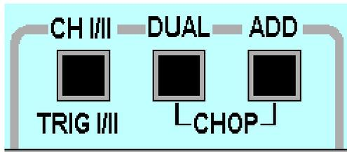
Au centre, en bas du panneau de contrôle inférieur, se trouve un groupe de trois boutons qui permettent de choisir quelle(s) trace(s) sera ou seront visible(s) à l'écran. On peut ainsi obtenir 8 affichages différents: un seul signal (CH1 ou CH2), les deux simultanément, l'un après l'autre, etc. Se reporter à la notice de l'appareil.
