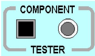
Certains scopes, comme celui-ci, sont dotés d'un **testeur de composants**, qui permet l'affichage de la caractéristique d'un composant. Pour ce faire, on enfonce le bouton. Dans tous les autres cas, ce bouton ne doit pas être enfoncé. Se reporter à la notice de l'appareil.
