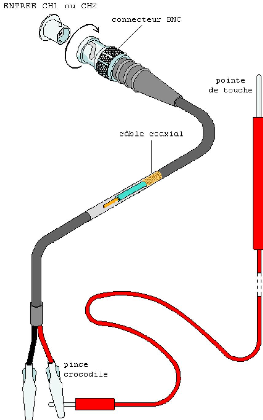
Le connecteur BNC doit être inséré dans la prise du scope (CH1 ou CH2, selon le cas); on pousse, puis on tourne. La pince croco du fil noir doit être reliée à 0 V ou GND. On utilise ensuite la pointe de touche (ou la pince croco du fil rouge, suivant ce qui s'avère le plus pratique) pour tester les différents points du circuit.
