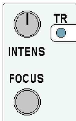
Sous le bouton Marche/Arrêt, les réglages **INTENS** et **FOCUS** permettent d'ajuster l'intensité lumineuse de l'affichage et la netteté de la trace. Si besoin est, la vis de réglage **TR** sera délicatement tournée à l'aide d'un petit tournevis pour obtenir une trace parfaitement horizontale en l'absence de signal.
