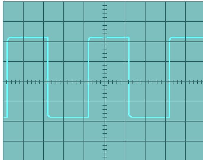
Vous pouvez affiner l'affichage en manipulant légèrement les boutons Y-POS 1 et X-POS. Observez l'effet (et l'utilité) de ces réglages. N'oubliez pas que les axes gradués vous permettent de mesurer des valeurs précises (amplitude en volts, fréquence ou période)!
