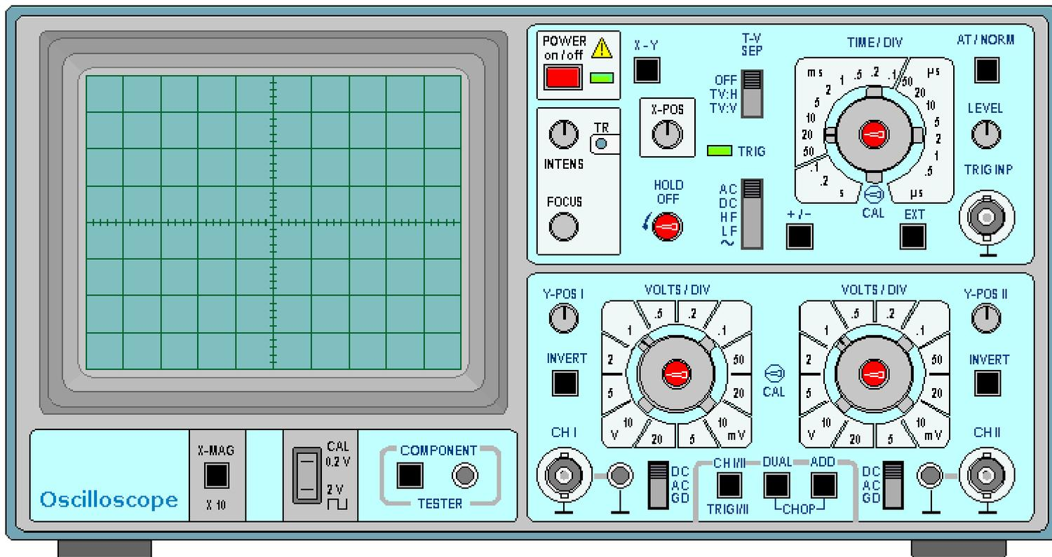
Tout d'abord, commençons par le plus facile: l'**écran**. Il comporte 8 divisions verticales (Y), et 10 divisions horizontales (X). On se souvient que l'axe Y est celui des tensions (volts) et l'axe X est celui du temps (time).
