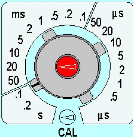
Voici maintenant l'un des réglages essentiels de l'oscilloscope: le rotacteur TIME/DIV. Il permet de faire varier le temps de balayage de 0,2 seconde à 0,5 μs.
