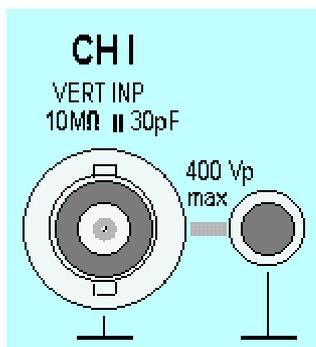
En bas de façade, on trouve les prises BNC des entrées **CH I** et **CH II**. C'est là que sont connectés les signaux d'entrée, à l'aide des sondes. Les petites prises sur le côté fournissent des entrées supplémentaires 0 V ou GROUND.
