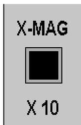
Lorsque le bouton **X-MAG** est enfoncé, l'échelle horizontale est multipliée par 10. Si par exemple TIME/DIV est réglé sur 1 ms/div, l'échelle passe 0,1 ms/div.
