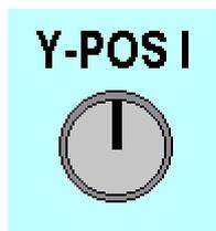
Chaque voie possède un réglage **Y-POS**, respectivement Y-POS I et Y-POS II. Ce bouton permet, à l'instar de son homologue X-POS, de déplacer la trace verticalement, vers le haut ou vers le bas. S'agissant d'un signal alternatif, on ajustera Y-POS de manière à ce que la ligne centrale de l'écran corresponde à 0 V.
