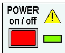
En haut à gauche, on trouve le bouton Marche/Arrêt (on/off), désigné **POWER**. Une DEL rectangulaire verte s'allume lorsque l'appareil est sous tension.
