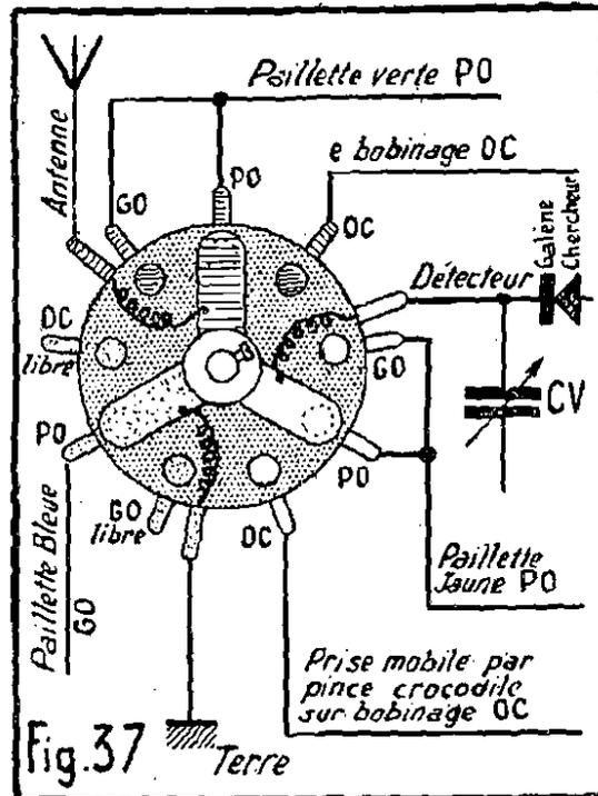
temps, sur l'une des 3 positions : OC, PO ou GO. D'où le nom de cet inverseur : tripolaire à trois directions.
