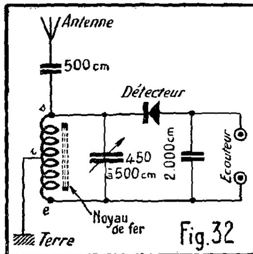
tours de fil. L'enroulement comporte, outre l'entrée e et la sortie s, une prise intermédiaire i qui permet d'obtenir le schéma de la figure 32.
