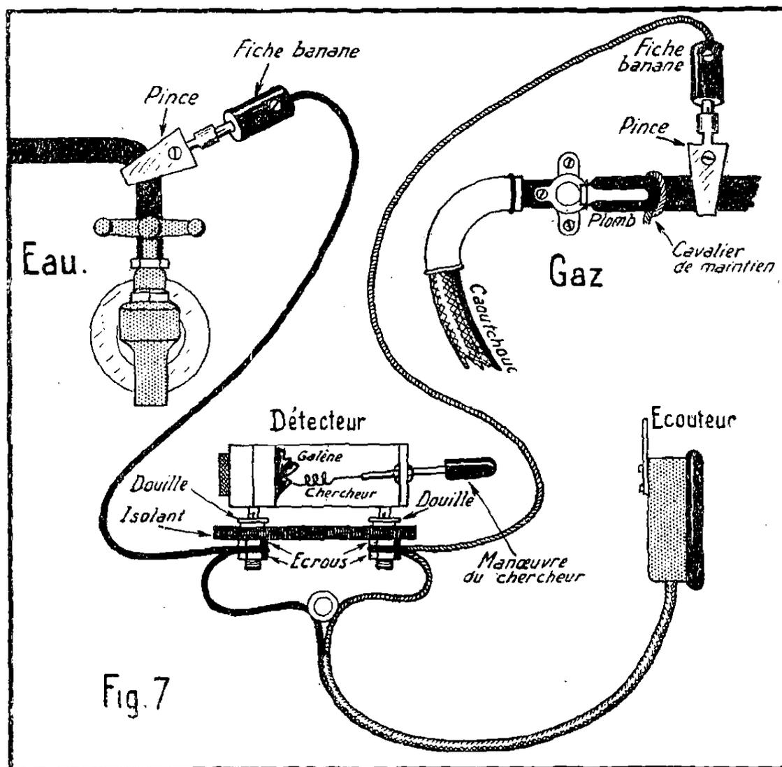
et clair de la figure 7 peut convenir à tout usager situé à une assez faible distance d'un émetteur. Voyons notre croquis : le détecteur étant branché aux deux fils de l'écouteur, l'ensemble est à son tour connecté : d'une part à la conduite d'eau, d'autre part à la conduite de gaz.
