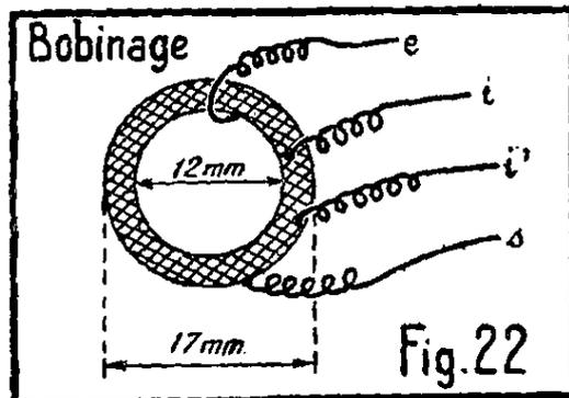
A gauche, le schéma fourni par le bobinage avec son entrée e, sa sortie s et ses deux prises intermédiaires i et i'. On voit ainsi la similitude de la réalité et du symbole.
