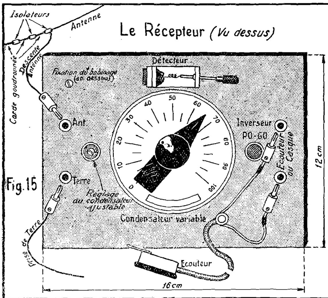
la figure 15 — vue dessus ou avant du poste — une plaquette de  $16 \times 12$  cm. On y fixera successivement :
