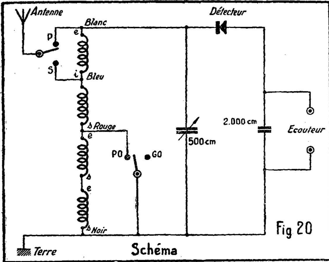
Ce schéma montre la double commutation possible : d'une part, celle de l'antenne allant à volonté sur Puissance ou sur Sélectivité, selon qu'il est nécessaire de donner la prédominance à l'une ou à l'autre. D'autre part, l'inverseur PO-GO.
