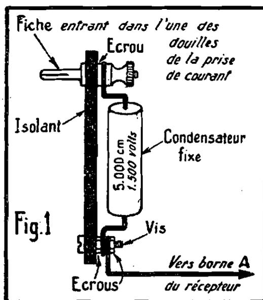
Mais notons bien que cette antenne, purement de fortune, n'est à envisager que si l'antenne théorique et normale ne peut être montée. A l'antenne-secteur, on peut toujours reprocher assez justement une longueur anormale, une disposition extravagante pour ce que nous en attendons et, de ce fait, nous risquons d'avoir des mécomptes, par exemple sous le rapport de la sélectivité.
