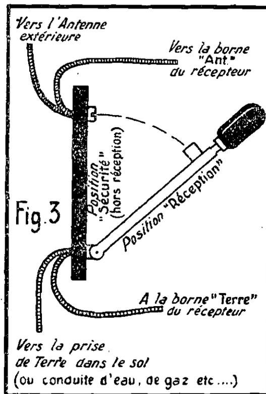
terre à l'antenne, en cas d'orage et en dehors de toute réception, évidemment. Cela s'appelle, direz-vous, mettre l'antenne à la terre ! Oui et non. Le résultat est équivalent. D'une façon et de l'autre, les charges accumulées par l'antenne sont dérivées à la terre ou sol et ne risquent plus, éventuellement,
