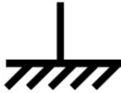
Figure 8 – Représentation schématique de la masse
