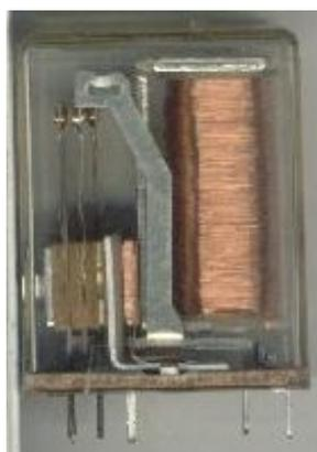
Figure 9 : photo d'un relais -
