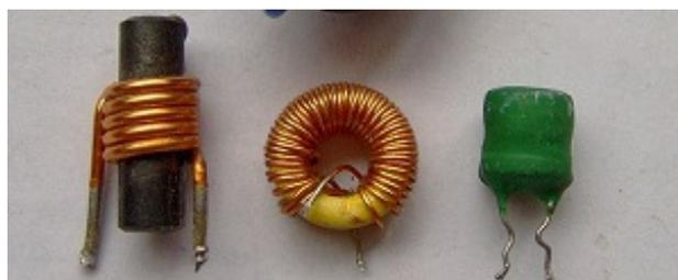
De gauche à droite : une bobine rectiligne, une bobine circulaire et une bobine moulée.
