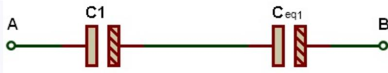
Figure 16 : condensateurs  $C_1$  et  $C_{eq1}$  en série
