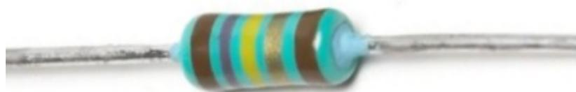
Figure 1 : résistor de type carbone
