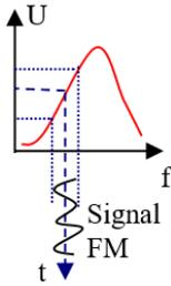
**b2** Le discriminateur de type **Travis** reprend le même principe que le détecteur de pente en réduisant son manque de linéarité. Il est composé de deux circuits oscillants calculés pour les fréquences extrêmes d'excursion (convertisseur équilibré). Quand la fréquence à démoduler se rapproche de  $FI - \delta F$ , la tension en A est supérieure à celle en B.
