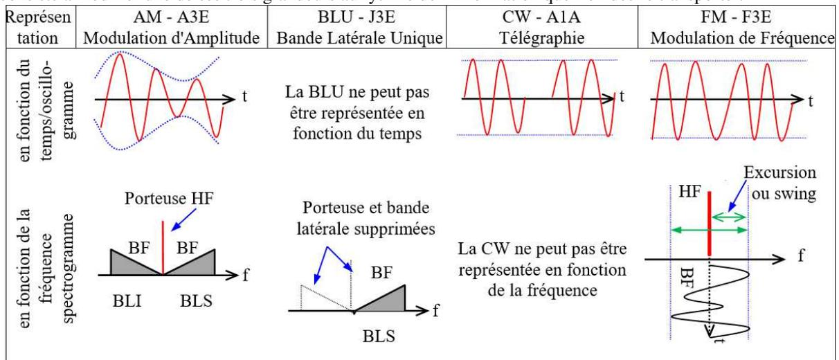
b) Un **oscillogramme** représente la modulation en fonction du temps qu'afficherait un oscilloscope. Un **spectrogramme** représente la modulation en fonction de la fréquence qu'afficherait un analyseur de spectre.
