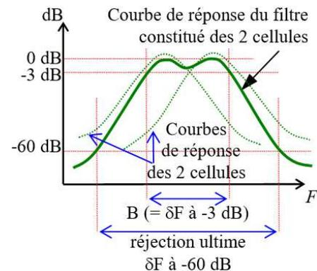
**Exemples :** dans le schéma ci-contre représentant la courbe de réponse d'un filtre passe bande, on mesure B = 5 kHz et δF à -60 dB = 25 kHz. Quels sont le taux de sélectivité et le facteur de forme du filtre ?
