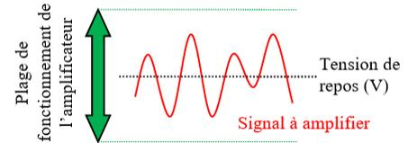
**a1** - La **classe A** est le montage le plus courant : le signal à amplifier est centré par rapport à la plage de d'amplification. La tension de repos est centrée sur cette plage et le signal à amplifier ne la dépasse jamais.
