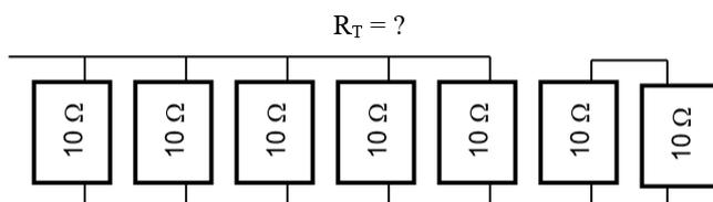
**Réponse :** les 5 résistances de gauche sont montées en dérivation et les 2 résistances de droite sont montées en série.
