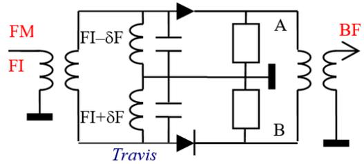
**b3** Le discriminateur de type **Foster-Seeley** démodule la modulation de phase (PM) grâce au déphasage introduit par le condensateur C dans le circuit oscillant de sortie.
