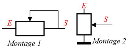
**d** Il existe des composants dont la résistance est variable (ou ajustable lorsque la valeur est définie une fois pour toutes). Ces résistances sont montées sur un axe ou sur un curseur et peuvent être déportées pour les réglages. Ces composants nommés aussi potentiomètres sont montés en résistances variables (montage 1) ou en pont diviseur (montage 2).
