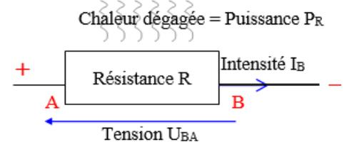
**f** En prenant des références hydrauliques, la tension est comparable à une différence de pression dans un tuyau et se mesure donc entre deux points d'un circuit. L'intensité est un débit et se mesure en insérant l'instrument de mesure en un point du circuit, comme un compteur d'eau. La résistance est comparable à un rétrécissement du tuyau. La chaleur dégagée par la résistance provient des frottements lors du passage des électrons.
