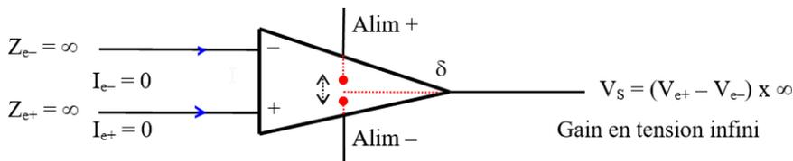
**b** Les amplificateurs opérationnels ont une **impédance d'entrée infinie** : aucun courant ne circule dans les entrées. L'impédance de sortie, théoriquement nulle, est très
