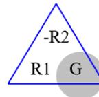
**2)** Un amplificateur opérationnel est monté en inverseur. Le gain du montage est de -3 avec une résistance à l'entrée (R1) de 10 000 ohms. Quelle est la valeur de la résistance de contre-réaction (R2) ?
