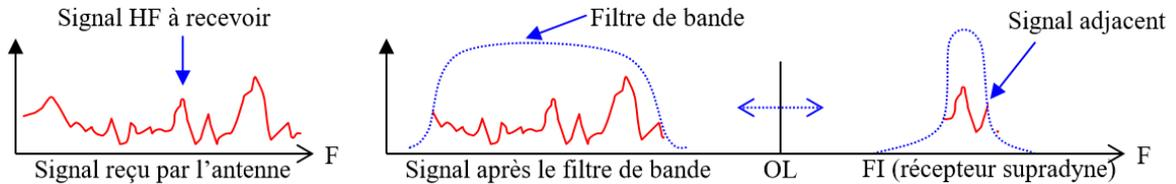
**d** L'antenne reçoit le signal HF que l'on souhaite recevoir mais aussi tous les autres. Le filtre de bande, avant le mélangeur, effectue un premier tri puis l'étage FI, grâce à sa sélectivité, extrait le signal désiré. Dans notre schéma, à droite du signal à recevoir, apparaît un signal adjacent qui pourra dégrader la réception une fois notre signal démodulé. Pour supprimer ce signal parasite, il faudrait un filtre FI avec une bande passante plus étroite.
