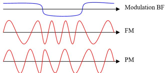
**b** La FM et la PM sont démodulées par un **discriminateur** qui transforme les variations de la fréquence du signal à démoduler en variations de tension BF. Lorsque deux signaux sont présents à l'entrée du démodulateur, seul le signal le plus fort sera démodulé, contrairement à l'AM (et à la BLU) où les deux signaux seront extraits.
