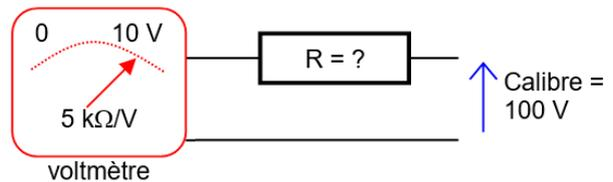
**b** Un bon voltmètre aura un Q au moins égal à 20.000  $\Omega/V$ , soit une intensité de déviation maximum  $I_g$  de 50  $\mu A$  (= 1 / 20.000). Pour les ampèremètres, le paramètre important est la résistance interne du galvanomètre. Plus celle-ci sera faible, meilleur sera l'appareil. Un bon appareil de mesure multimètre aura donc une tension de déviation maximum la plus faible possible (faible résistance interne et faible intensité de déviation maximum)
