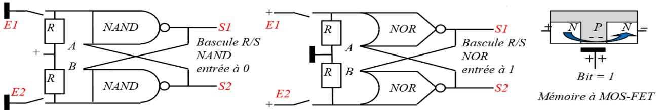
**Bascule R/S NAND :** E1 est à 0 (interrupteur fermé) ; si A est à 0, alors S1 est à 1 et E2 est à 1 (grâce à R), B aussi (=S1) ; S2 est à 0, A est donc bien à 0 et S1 reste à 1 (même si E1 n'est plus à 0). Si A est à 1, E1 étant à 0, S1 est toujours à 1, donc la valeur en A n'influence pas le système. Si E2 passe à 0, S2 passe à 1 et S1 à 0.
