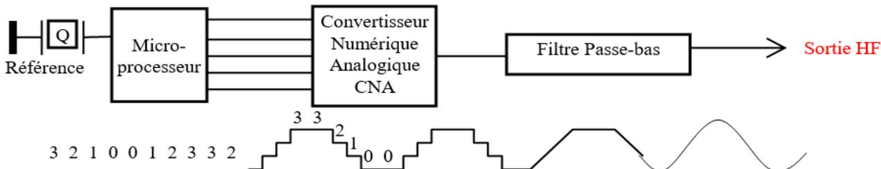
Avec un programme adapté (algorithmique), le microprocesseur génère la fréquence par **échantillonnage** : un chiffre représentant la tension à générer est calculé selon une cadence très stable générée par un quartz. La
