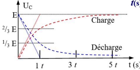
$$t(s) = R(\Omega) \cdot C(F) \text{ ou } t(ms) = R(k\Omega) \cdot C(\mu F)$$
