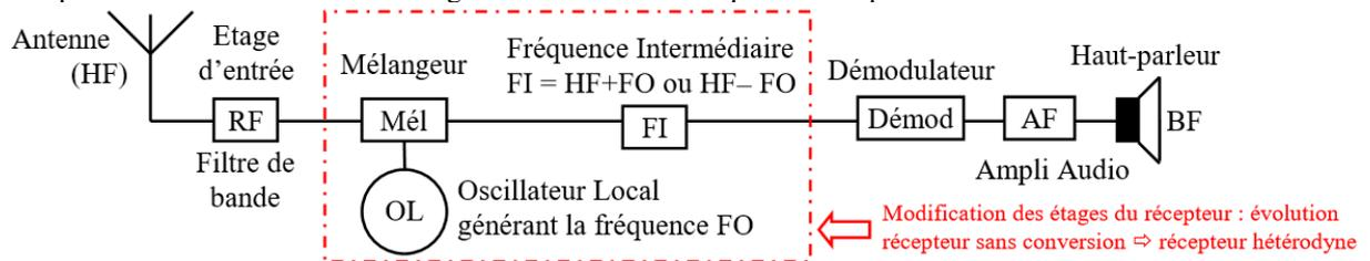
**b** Les fréquences de l'oscillateur local (FO), de la fréquence à recevoir (HF) et de l'étage de fréquence intermédiaire (FI) sont calculées de telle manière que l'on a :
