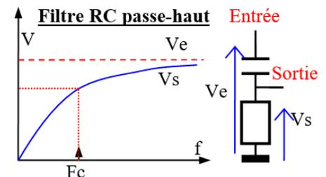
**Exemple :** Quelle est la fréquence de coupure du filtre RC représenté ci-contre ?
