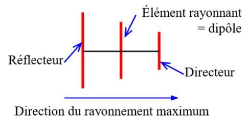
**a 9.7) Le gain d'une antenne** se mesure dans la direction maximum de rayonnement. Le gain se calcule en dB par rapport à l'antenne doublet (dB<sub>d</sub>) ou encore par rapport à l'**antenne isotropique** (dB<sub>iso</sub>). Celle-ci est une antenne idéale : un point qui rayonne et dont le diagramme de rayonnement est une sphère. Isotropique qualifie un corps (pas obligatoirement une antenne) ayant des propriétés physiques uniformes dans toutes les directions.
