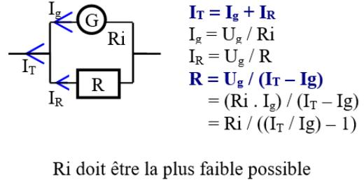
**Exemples :** nous disposons d'un galvanomètre dont les caractéristiques sont les suivantes : intensité de déviation maximum = 20  $\mu A$  et résistance interne = 10  $\Omega$ . Comment réaliser un voltmètre dont le calibre est de 10 volts et un ampèremètre dont le calibre est 1 ampère ?
