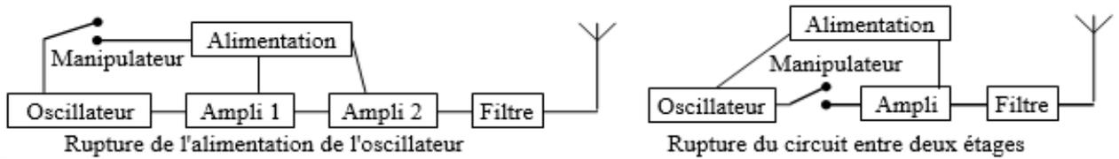
**c** Lorsque le signal est modulé par rupture de l'alimentation de l'oscillateur, la stabilité de ce dernier peut être détériorée ce qui génère des **piaillements** en réception. La manipulation par rupture entre les étages provoque, quant à elle, d'importantes variations d'impédance de charge des étages suivants, pouvant générer des **claquements** en réception. La CW est démodulée de la même manière que la BLU (voir § suivant).
