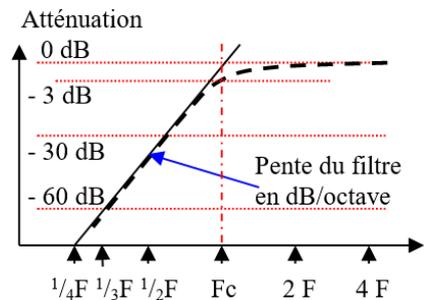
Dans ce graphique, la pente a son origine à la fréquence de coupure ( $F_c$ ). La courbe d'atténuation (en trait coupé gras sur le graphique) est asymptotique à cette pente puis, au delà de la fréquence de coupure, la courbe devient asymptotique à l'axe indiquant 0 dB. Le graphique ci-dessus représente un filtre passe haut. Pour un filtre passe bas, la courbe est inversée (la pente est négative) mais les caractéristiques sont les mêmes.
