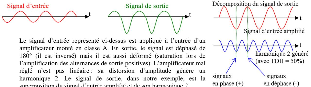
Le signal d'entrée représenté ci-dessus est appliqué à l'entrée d'un amplificateur monté en classe A. En sortie, le signal est déphasé de 180° (il est inversé) mais il est aussi déformé (saturation lors de l'amplification des alternances de sortie positives). L'amplificateur mal réglé n'est pas linéaire : sa distorsion d'amplitude génère un harmonique 2. Le signal de sortie, dans notre exemple, est la superposition du signal d'entrée amplifié et de son harmonique 2.
