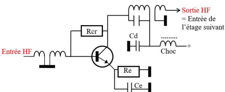
Cet amplificateur est constitué de filtres HF (circuit bouchon) et de circuits spécifiques :
