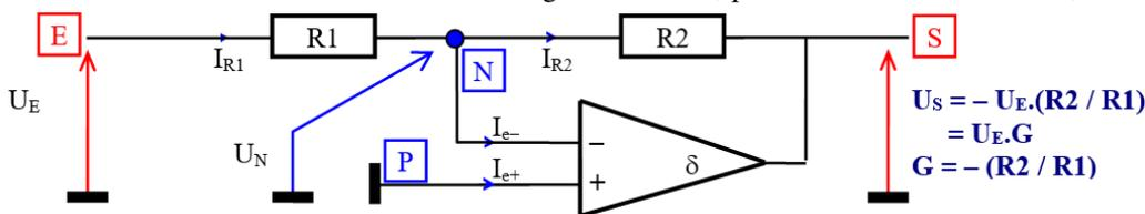
$U_N$  atteindra une valeur inférieure à  $U_P$ , la sortie basculera vers le + de l'alimentation du circuit, ce qui, par la contre-réaction de
