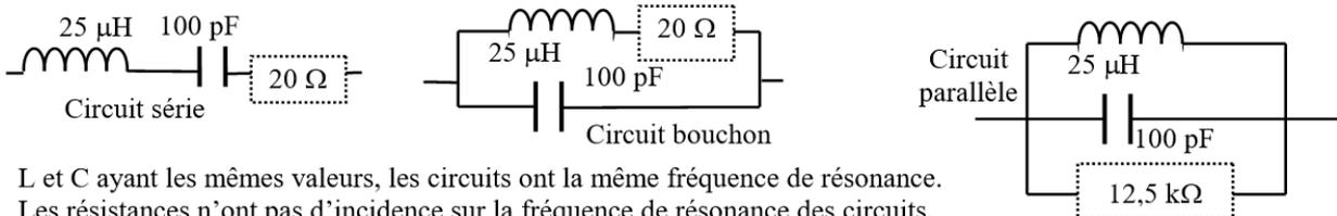
L et C ayant les mêmes valeurs, les circuits ont la même fréquence de résonance. Les résistances n'ont pas d'incidence sur la fréquence de résonance des circuits.
