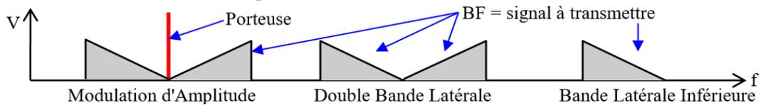
**b** La tension du signal AM en fonction du temps,  $S(t)$ , s'écrit (avec  $K =$  taux de modulation,  $P =$  tension crête de la porteuse sans modulation ( $= B/2$ ),  $F =$  fréquence de la porteuse et  $f =$  fréquence de la BF modulante) :
