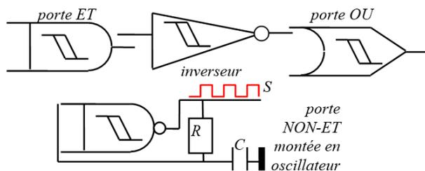
**c** La logique TTL fonctionne avec des tensions 0 V et 5 V. Mais lorsque la tension n'atteint pas ces valeurs extrêmes ou lorsque la tension passe de 0 à 5 V (ou l'inverse), le circuit logique auto-oscille. L'endroit, mal défini, entre le 0 et le 1 est dû à l'**hystérésis**. Le trigger de Schmitt est conçu spécialement pour éviter ce problème : la tension de transition de l'état 0 à 1 est supérieure à la tension de transition de 1 à 0. Ce montage peut être intégré à tous les circuits logiques.
