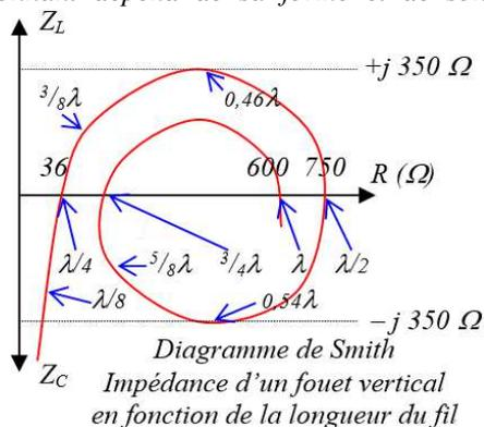
**f) Rendement d'une antenne** : comme toute charge, une antenne a un rendement. Celui-ci est le rapport de la puissance émise par l'antenne par rapport à la puissance appliquée à celle-ci. En appliquant la loi d'Ohm, le rendement, exprimé en %, est aussi le rapport obtenu en divisant l'impédance de rayonnement (ce qui est émis par l'antenne) par l'impédance totale de l'antenne (ce qui est vu par la ligne de transmission).
