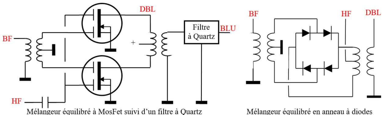
Dans le **mélangeur équilibré à diodes**, le sens des diodes est différent de celui du pont redresseur : les diodes sont les unes derrière les autres (en anneau). Le mélangeur à diodes est monté dans un boîtier à quatre broches (2 entrées, 1 sortie et une masse) intégrant non seulement les 4 diodes mais aussi les transformateurs.
