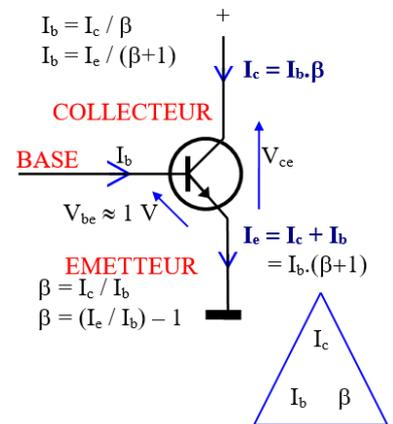
**Exemple :** sur la base d'un transistor dont le gain ( $\beta$ ) est de 80 est appliqué un courant de 500  $\mu$ A. Quelle intensité est constatée sur le collecteur du transistor (en mA)? **Réponse :**  $I_c = I_b \cdot \beta = 500 \mu\text{A} \times 80 = 40\,000 \mu\text{A} = 40 \text{ mA}$
