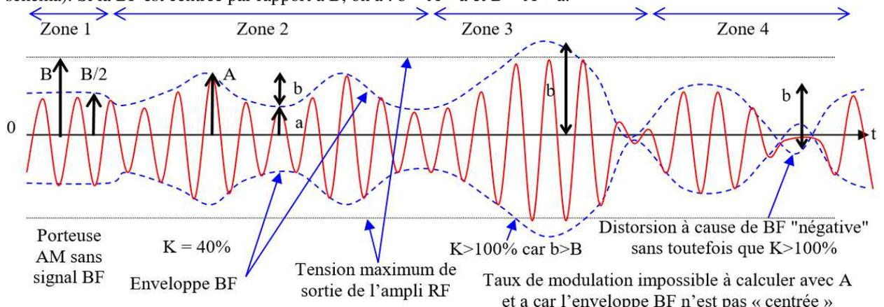
Si l'enveloppe BF passe au dessus de « B » (zone 3) ou si l'enveloppe BF passe en dessous de 0 (zone 4), il y a **surmodulation** et distorsion du signal BF puisqu'une partie de celui-ci n'est pas émis. La modulation est optimisée lorsque la valeur « b » est la plus grande possible, sans toutefois que l'enveloppe BF dépasse les deux limites énoncées ci-dessus (0 et B) car, au-delà, les distorsions sont sévères.
