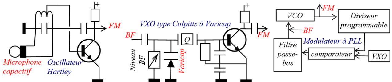
**e** On appelle **indice de modulation** ( $m$ ) le rapport obtenu en divisant l'excursion de fréquence (soit la moitié de la bande passante du signal FM,  $\delta F$ ) par la fréquence maximum du signal modulant (BF) :  $m = \text{Excursion (Hz)} / \text{BF maxi (Hz)}$
