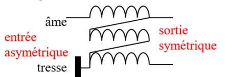
Représentation d'un balun en tension 1/1 : en haut, réalisation d'un bobinage « 3 fils en main » ; ci-contre, les trois fils sont représentés l'un à la suite de l'autre.
