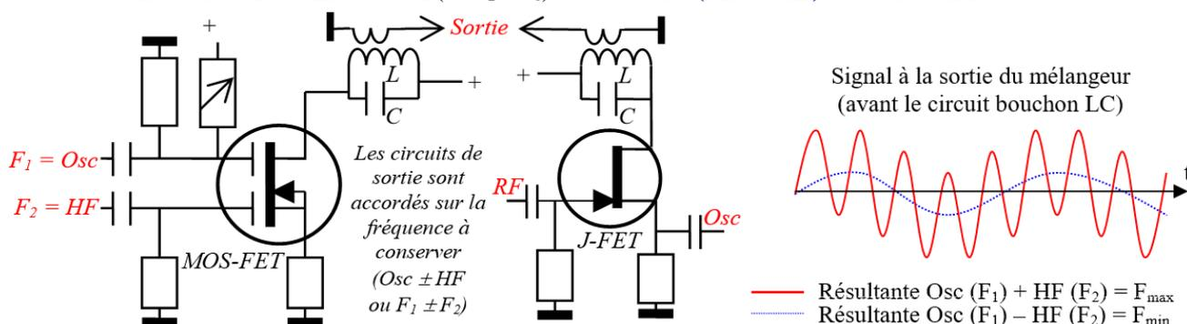
**Exemples : 1)** À l'entrée d'un mélangeur, on a 5 et 8 MHz. Quelles fréquences trouve-t-on à la sortie du mélangeur ?
