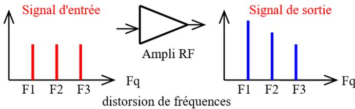
**b1** Il y a une **distorsion de fréquences** lorsque, selon sa fréquence, le signal de sortie n'est pas proportionnel au signal d'entrée. Les fréquences élevées peuvent être moins amplifiées que les fréquences basses (ou l'inverse ou une bande de fréquence est plus amplifiée que les autres). Cette distorsion survient quand il y a un circuit accordé (filtres LC, RC, RL)
