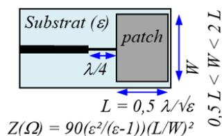
**k** Une **antenne patch** est une structure résonnante en surface constituée d'un rectangle conducteur monté sur un plan de masse séparé d'un diélectrique (substrat),  $\epsilon$  étant la permittivité relative du diélectrique (voir §2.3c4). Pour les longueurs, il faudra tenir compte de la vitesse ( $1/\sqrt{\epsilon}$ , voir §10.2b). Le diagramme de rayonnement est presque hémisphérique au dessus de la surface du patch.
