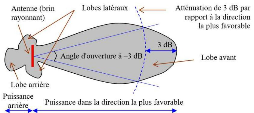
Concrètement, pour mesurer l'angle d'ouverture d'une antenne, on se cale en réception sur une station dont on mesure le signal au S-mètre. Puis on fait tourner l'antenne jusqu'à ce que le signal diminue de moitié (1/2 point S-mètre). On note l'angle d'azimut. Puis on fait tourner l'antenne en sens contraire jusqu'à obtenir la même puissance de signal. L'angle d'ouverture est l'écart entre les deux angles d'azimut.
