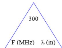
**Exemples :** 1) Quelle est la longueur d'onde d'une fréquence de 14,1 MHz?
