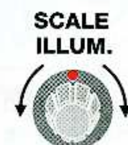
Figure 7: Le bouton "SCALE ILLUM." est utilisé seulement pour illuminer le réticule de l'écran afin de mieux visualiser la position occupée par le signal.
