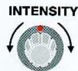
Figure 5: Le bouton "INTENSITY" placé sous l'écran, comme le montre la figure 1, sert à régler la luminosité du tracé du signal visualisé.
